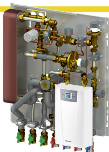
Die Wohnungsübergabestation mit integriertem Heizkreis und Plattenwärmetauscher und mit integriertem E-Durchlauferhitzer, dient zur hygienischen Trinkwasserversorgung in einer Wohnung.
